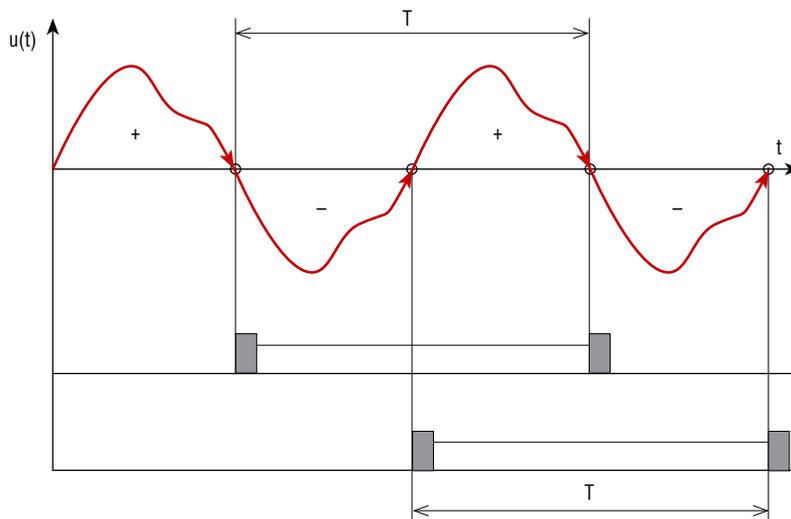
Рис. 1. Принцип измерения частоты искаженного периодического сигнала
