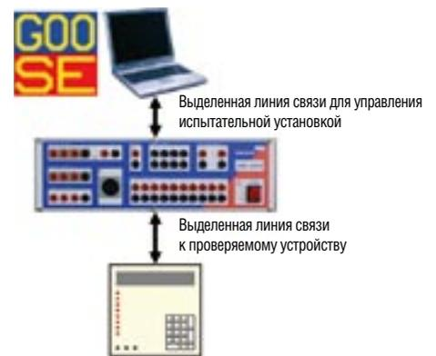
**Рис. 3.** Идеальная схема установки с выделенными линиями связи
