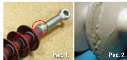
**Рис. 1.** Клеевая (шашлычная) конструкция с кремнийорганической защитной оболочкой. Частые случаи разгерметизации многочисленных швов приводят к внутреннему увлажнению изоляторов и их выходу из строя
