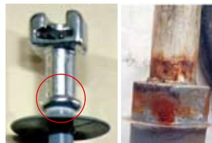
**Рис. 4, 5.** Цельнолитой изолятор с кремнийорганической оболочкой и клеевой герметизацией узла сопряжения оконцевателя с защитной оболочкой
